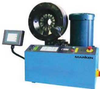
K60 Máquina Crimpadora hasta 4"
