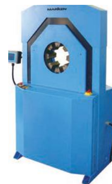
K400 Máquina Crimpadora hasta 8"
