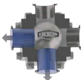
4-vías puerto 'L' posición A
