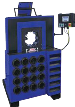
CC600 Máquina Crimpadora hasta 6"
